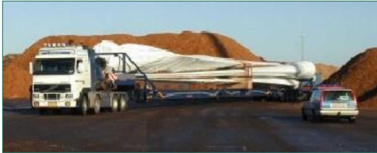
Figure 64 : Transport sur remorque des pales
